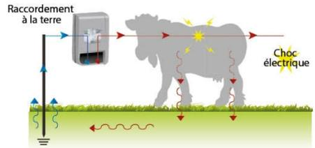
**Fig. 4 - Installation de l'électrificateur**
