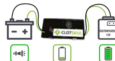
> Sonnerie type « chant d'oiseaux » (pour la discrétion) se met en fonctionnement quelques jours avant une décharge trop importante de la batterie (environ 11.7 volts).
